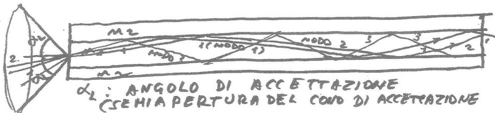
CALCOLO DELL'APERTURA NUMERICA N.A. DI UNA FIBRA OTTICA
