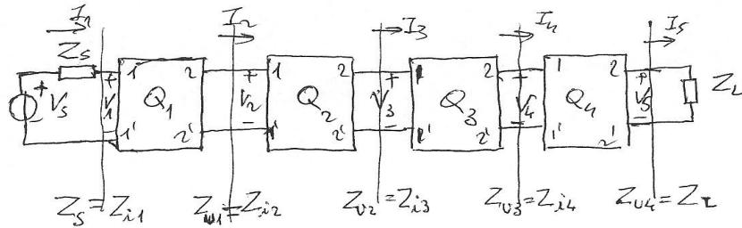
In parallelo l'impedenza d'ingresso di  $Q_1$  deve superare l'impedenza del generatore e l'impedenza d'uscita di  $Q_4$  deve superare l'impedenza di carico; in tal modo le correnti di quadripoli servono ad unico quadrupolo avente  $Z_s$  e  $Z_L$  come valori delle impedenze immaginate.
