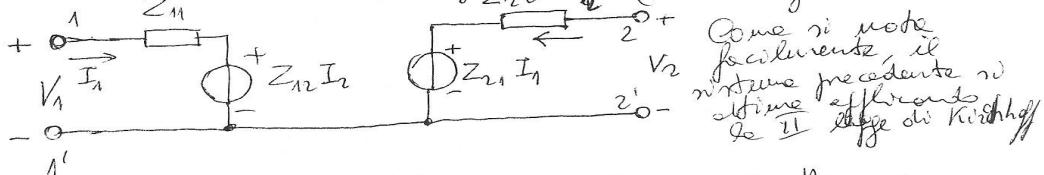
Consideriamo inoltre il quadripolo con struttura a T ed esso equivalente e contenente un solo generatore nella uscita d'usuale:
