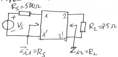
Coefficiente di trasduzione di un quadripolo assimmetrico chiuso nelle impedenze immaginari.
