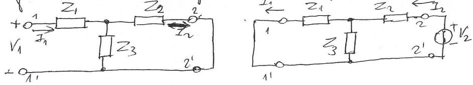
$$I_2 = \frac{V_1}{Z_1 + \frac{Z_2 Z_3}{Z_2 + Z_3}} \cdot \frac{Z_3}{Z_2 + Z_3} = \frac{V_1 Z_3}{Z_1 Z_2 + Z_2 Z_3 + Z_1 Z_3}$$
