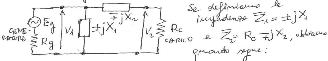
a) Si calcola l'impedenza totale  $\bar{Y}_{1,2} = \bar{Y}_1 + \bar{Y}_2$ , con
