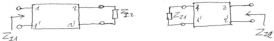
Se consideriamo più quadripoli assimmetrici collegati in cascata, l'adattamento di impedenze tra generatore e carico si ottiene facendo in modo che in corrispondenza del collegamento fra l'uscita di un quadripolo e l'ingresso del successivo si veda la stessa impedenza da entrambi le parti della connessione:
