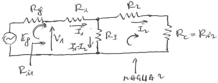
$$-(I_1 - I_2)R_3 + R_2 I_2 + R_c I_2 = 0$$
