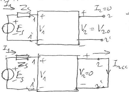
$$Z_U = \frac{V_{20}}{I_{acc}} \quad \text{dipende dall'impedenza } Z_s \text{ del generatore } E_s$$
