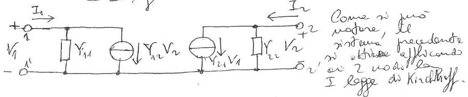
Consideriamo inoltre il quadripolo equivalente con struttura a  $\Pi$  e contenente un solo generatore nel modo d'uscita (generatore di corrente controllato da  $V_1$ )
