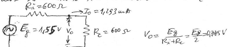
I valori più frequenti delle impedenze di linea sono i seguenti: 600  $\Omega$ , 150  $\Omega$ , 75  $\Omega$ , 50  $\Omega$ .
