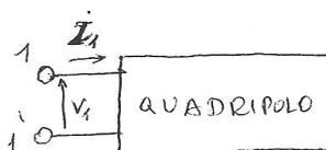
La rete quadripolare è accessibile dall'esterno soltanto attraverso i quattro terminali, che consentono di descrivere le caratteristiche funzionali mediante le tensioni,  $V_1$  e  $V_2$  e due correnti,  $I_1$  e  $I_2$ , indipendentemente dalla struttura circuitale interna.
