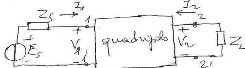
Si definisce impedenza d'ingresso  $Z_i$  il rapporto tra la tensione  $V_1$  che è morsetto d'ingresso e la corrente  $I_1$  assorbita dal circuito (punto) d'ingresso, per un determinato valore dell'impedenza di carico  $Z_L$ ; pertanto l'impedenza d'ingresso  $Z_i = \frac{V_1}{I_1}$  dipende dal carico  $Z_L$ .
