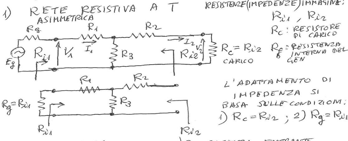
SE  $K = \frac{P_1 V_1 I_1}{P_2 V_2 I_2} = \text{ATTENUAZIONE DI POTENZA}$   $P_1$ : POTENZA ENTRANTE
